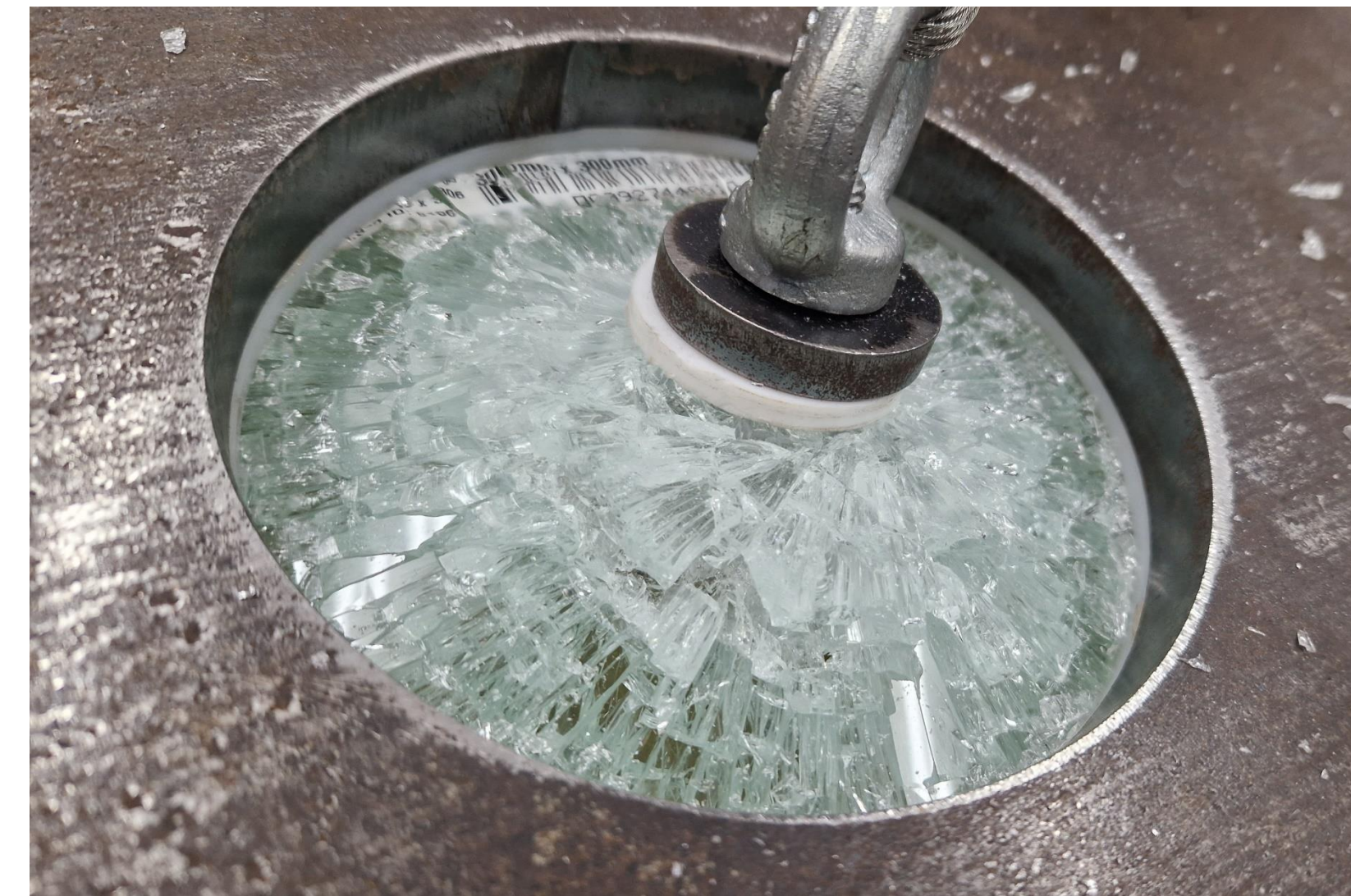
Rys. 14. Zniszczenie próbki o grubości 12 mm z krążkiem o średnicy 75 mm.
