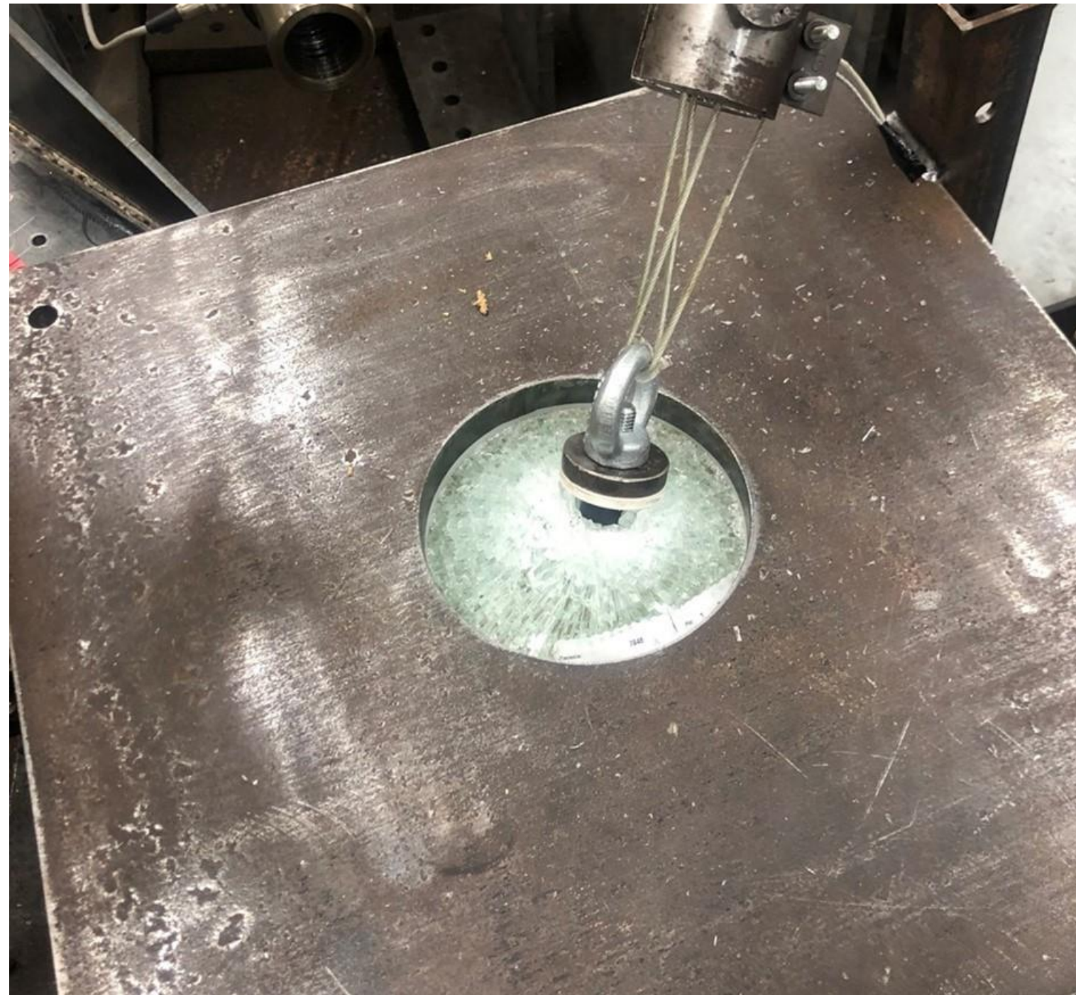
Rys. 5. Widok wyrwanego gniazda.
