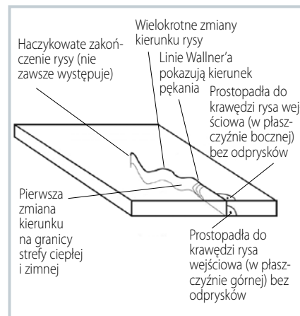
Schemat pęknięcia (rysy) wywołanego naprężeniami termicznymi w szkłe niehartowanym
