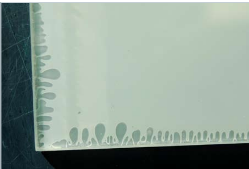
Fot. 4. Rozwarstwienie w szkłe warstwowym poddanym oddziaływaniu wilgoci (95%) i temperatury (50°C)
