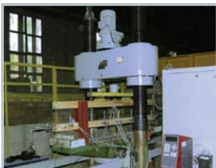
Fot. 1. Hybrydowa belka drewniano-szklana w próbie czteropunktowego zginania [1]
