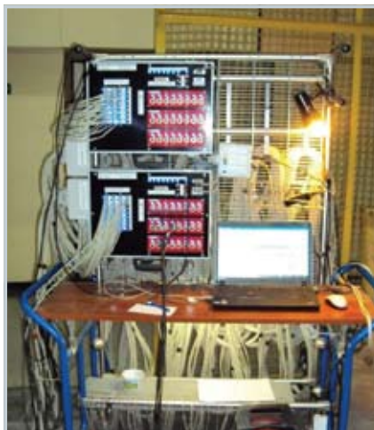
Fot. 2. 128-kanalowy przetwornik sygnału i komputer wyposażony w oprogramowanie MLAB 32 [1]
