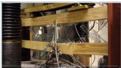
Fot. 6. Całkowite zniszczenie belki BA2 [materiały własne autorów]
