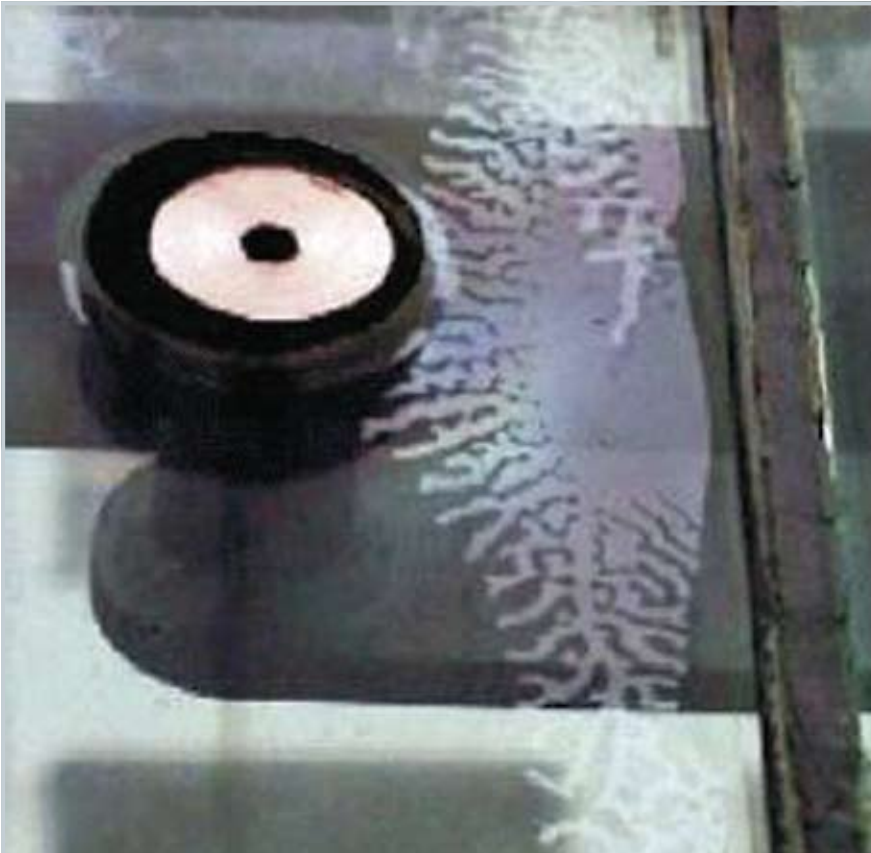
Fot. 3. Rozwarstwienie szkła warstwowego wskutek oddziaływania silikonu w szybie zespolonej
