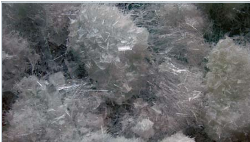
Fot. 2. Spieniona warstwa ognioodporna
